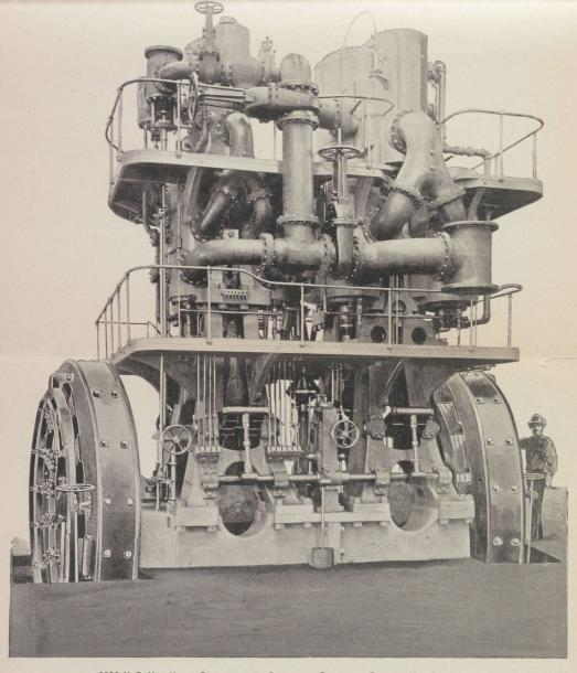
2500 H. P. VAN VLECK DISCONNECTIVE QUADRUPLE EXPANSION ENGINE.-NEW STATION.
